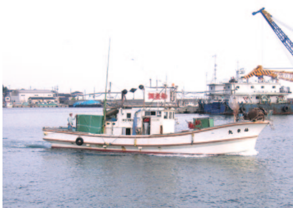
図4 能登半島の沿岸海域調査に用いた船。ブーマーを音源とするマルチチャンネルシステムは、この大きさの船にも搭載可能である。
