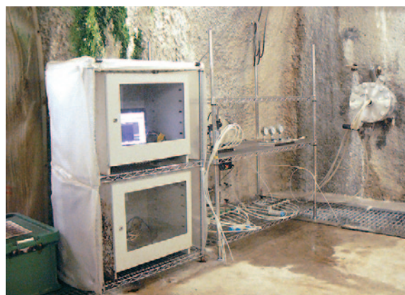
写真1 瑞浪超深地層研究所深度300m坑道での水質モニタリング装置。右奥が延長100mの水平ボーリング孔、手前のボックス内の装置で水圧の連続観測を行い、中央のバルブから深度ごとの地下水試料を採取しています。
