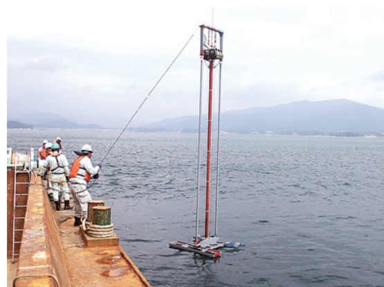
図3 バイブロコアラー。上についている箱がバイブレーター。
