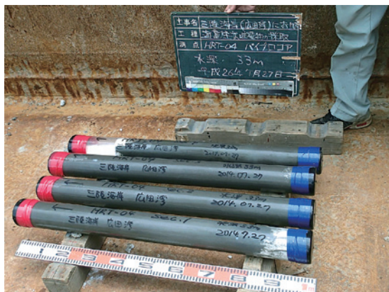
図4 パイプコアラーによって採取された長さ約4 mのコア試料。
