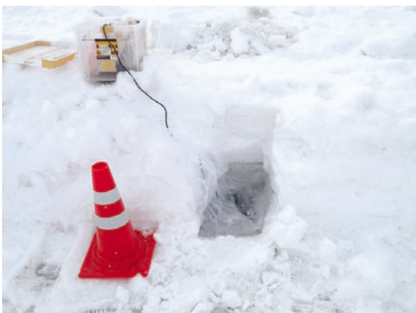
写真 地震計の雪中への埋設の様子。
