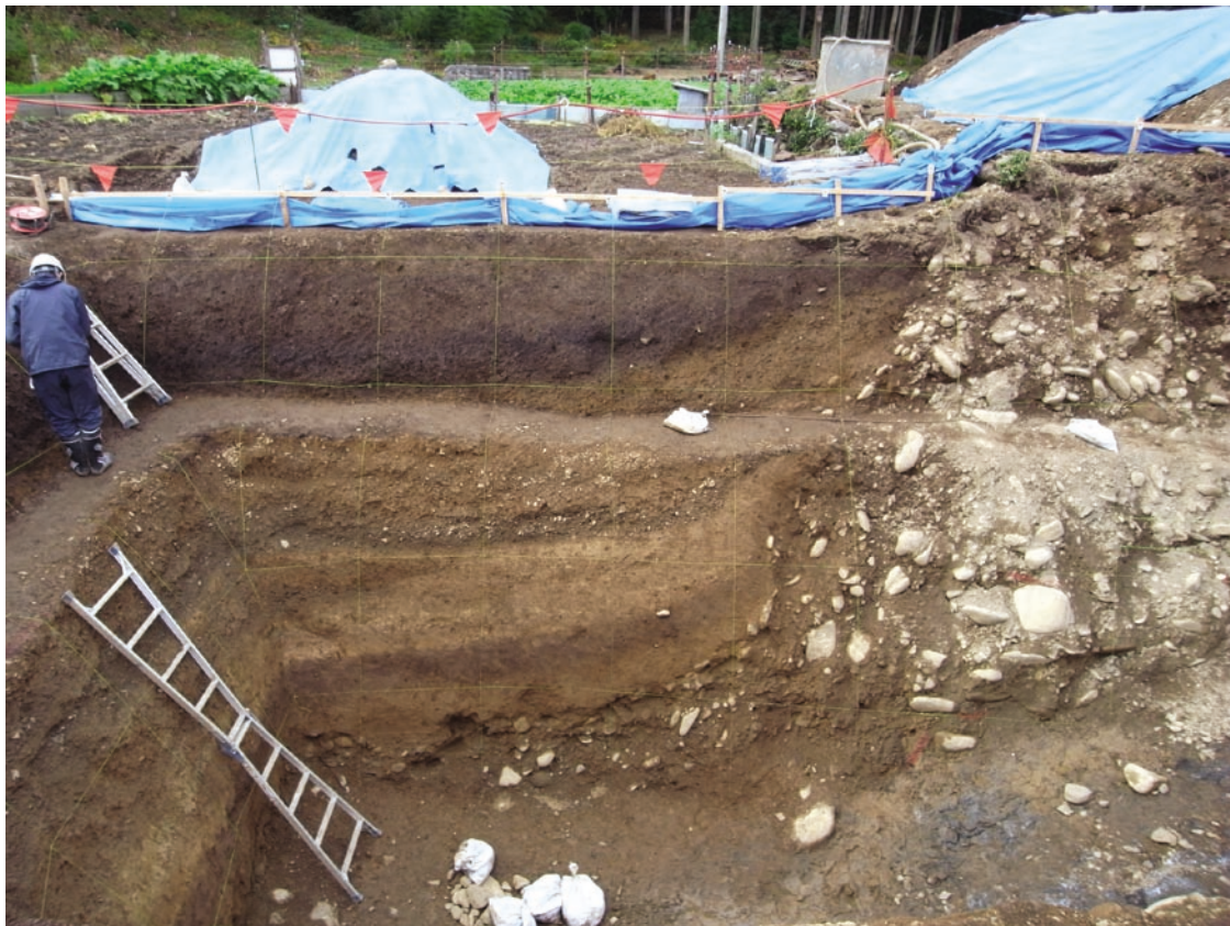
図7 大井トレンチ北西壁面の写真。左側のダムアップ堆積物と右側の低位段丘礫層が見かけ高角の正断層を境に接している。断層近傍ではダムアップ堆積物のたわみ上がりと段丘礫の直立が明瞭。グリッド間隔は1 m。
