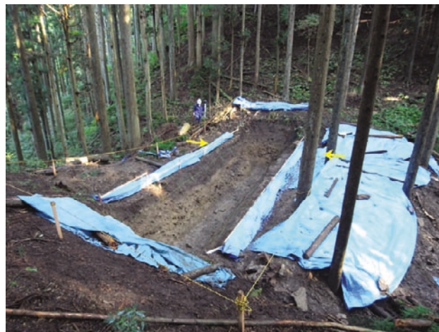
図3 奥谷平曾洞地点、風隙トレンチの全景写真。北をのぞむ。河川争奪により形成された風隙を完全に横断する形で掘削を行った。黄色矢印は断層出現位置を示す。
