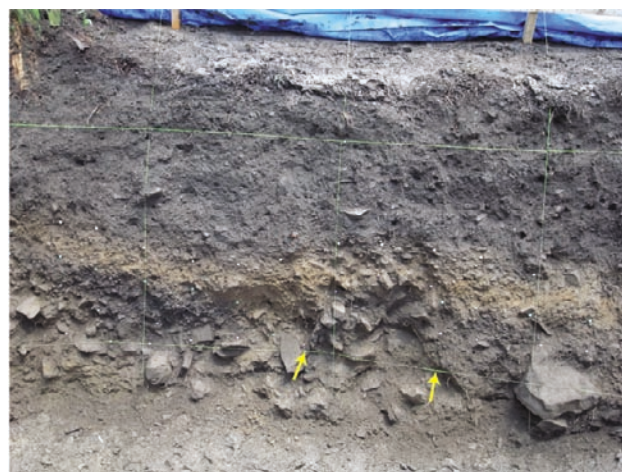
図4 奥谷平曾洞地点、風隙トレンチ南東壁面の写真。断層推定位置を黄色矢印で示した。グリッド間隔は1 m。
