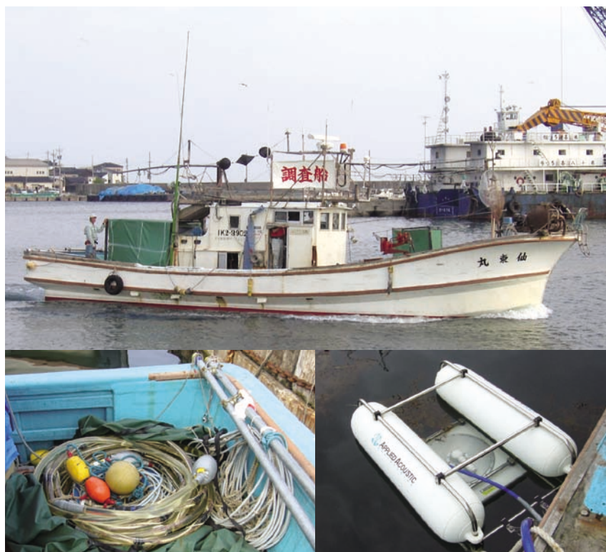
図3 調査船と調査機器. 左下：12チャンネルストリーマー，右下：ブーマー音源.
