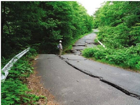
写真1. 市道馬場一駒ノ湯線を横切る地表地震断層。右横ずれ量は4~5m。
