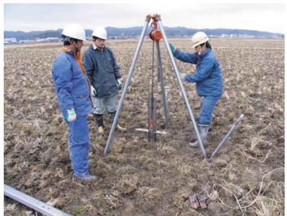
図4 ジオスライサーの引き抜き作業。
