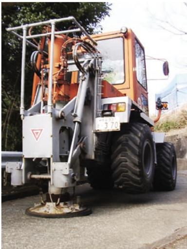
図1. 国府津-松田断層帯松田北断層での浅層反射法地震探査発震作業。写真の震源車は地球科学総合研究所所有中型インパクト震源 JMI-200。
