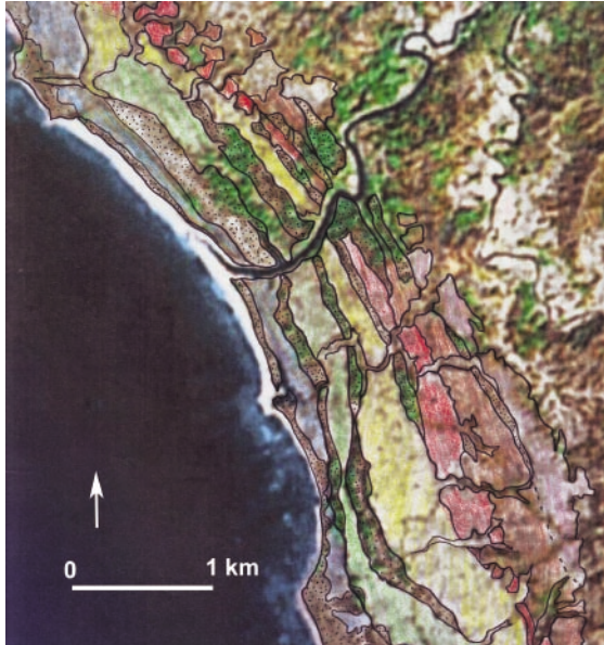
図3 写真判読に基づいて作成した段丘面区分図の一例 (Site 2)。ここでは6面の段丘が識別される。
