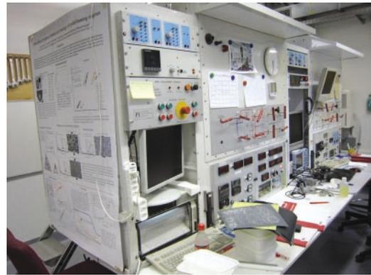
スイス連邦工科大学の高温高压剪断試験機．
