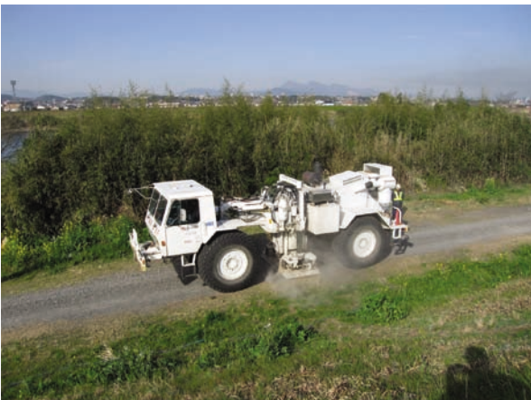
写真1 パイプロサイス車による発震の様子。
