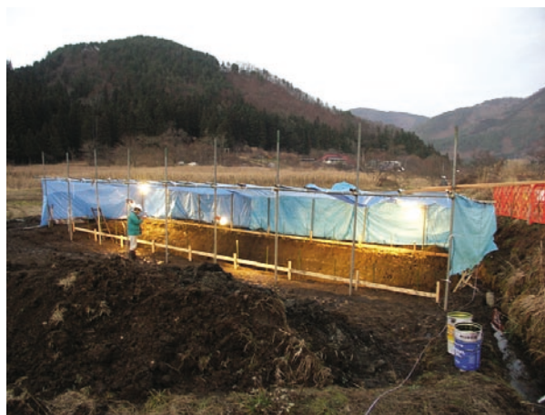
荒天対策のために覆いをされたトレンチの夕景。右手には人工改変された低断層崖。
