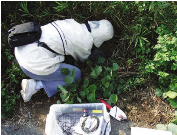
写真1 地震計設置の様子。最長3時間近く置いたままにするため，交通の邪魔とならないよう道路脇に場所を探して設置した。
