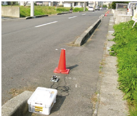
写真2 地震計アレイの様子。赤いコーンが立っている箇所に地震計が置かれている。正三角形を構成するよう設置したが，直線しか見えないのはその1辺しか撮れていないため。
