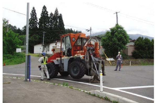
花輪東断層帯のP波反射法地震探査状況
