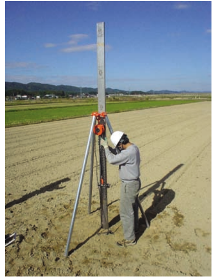
写真2 ジオスライサーによる堆積物採取風景。
