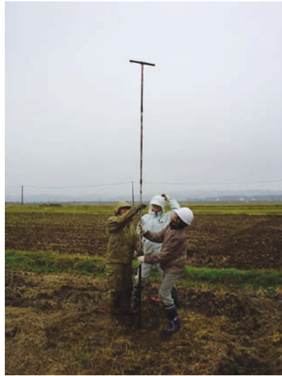
写真1 ピートサンプラーによる堆積物採取風景。
