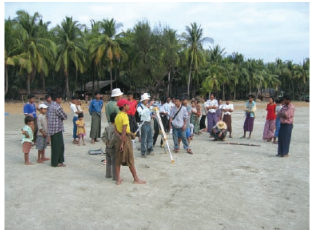
写真4 Thandwe 南方の上陸した浜で2004年の津波の波高を測量する。
