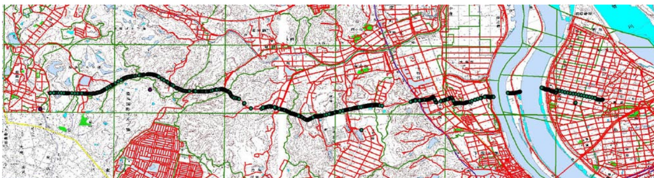
図5 GPS測量の結果（緑色の○）と数値地図2500（空間データ基盤）（赤線）の比較。
