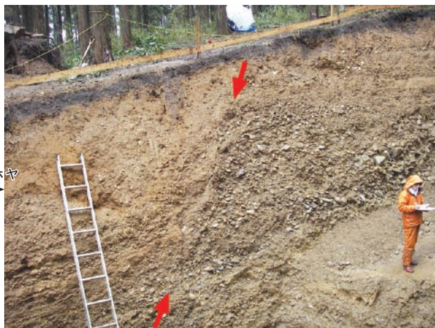
宮の谷トレンチ東側壁面（矢印の間が断層）。
