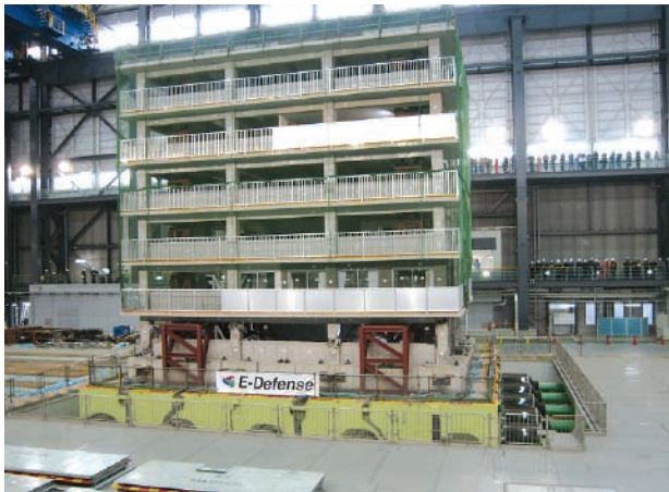
振動台に載る実大6層建物(最終加振後に撮影)。
