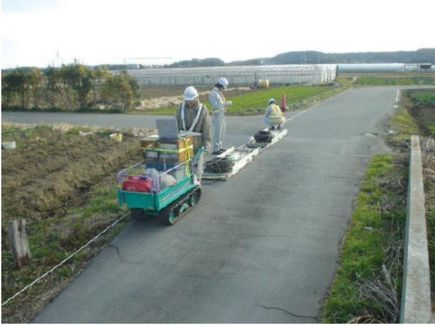
連続波レーダーを用いた地下構造探査の様子
