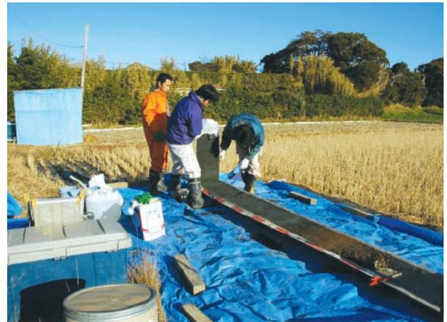
抜き取った地層のはぎ取り試料採取の様子
