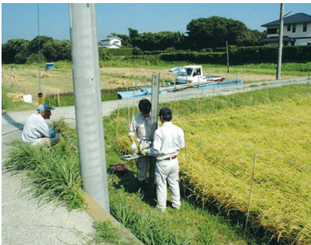
富浦における堤間湿地でのハンディジオスライサー調査の様子。
