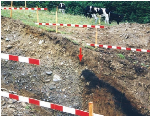
写真5 ソグラ沢トレンチの壁面とトレンチを見学に来た牛。左側の礫層と右側のローム層との境界に、黒色土壌の落ち込みを伴う断層（矢印）が見られる。
