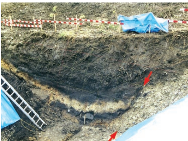
写真3 寄合渡トレンチの壁面 黒色土壌に挟まれた白っぽい地層（泥流堆積物）が断層（矢印）で切られている。
