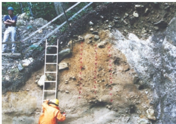
富山県牛首断層のトレンチ調査 右側の白っぽい岩盤が左側の地層の上に乗っているのがわかる。
