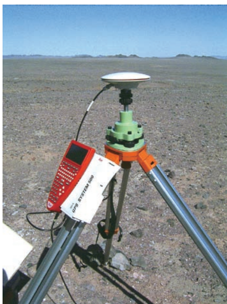
写真8 測量に用いたGPS（基準点側）
