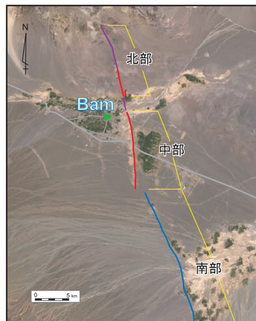
図1 バム断層のセグメント区分 赤線は今回の地震によって地表亀裂が現れた区間を、青線は地表亀裂が現れなかった区間を、紫線は今回の調査では地表亀裂の有無を確認できなかった区間をそれぞれ示す。
