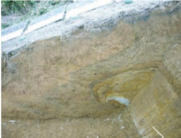
白炭東断層のピット調査で確認された逆断層。西傾斜の低角逆断層によりM2面構成層とローム層が切られている。(後藤氏撮影)
