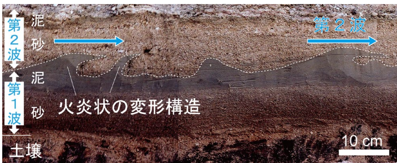
図3 タイの海岸低地でみられた津波堆積物。厚さ30-50cm程度の津波堆積物の中に2つの級化ユニットがあり、その境界が火炎状に変形している様子がみられる。Matsumoto et al. (2008) を改変。
