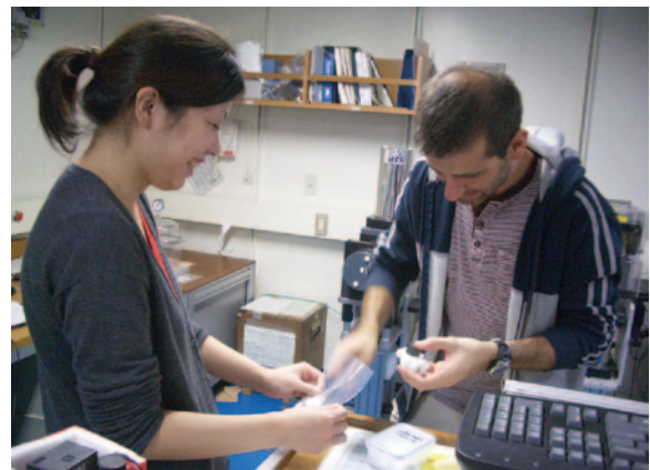
写真1. 「ちきゅう」での研究活動。(左) 回収されたばかりのコア試料の空隙からガスを採取している様子。(右) 堆積物のP波速度・比抵抗測定の様子。
