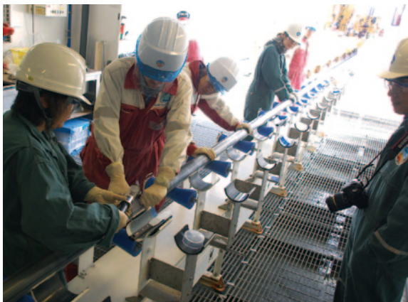
写真1. 「ちきゅう」での研究活動。(左) 回収されたばかりのコア試料の空隙からガスを採取している様子。(右) 堆積物のP波速度・比抵抗測定の様子。
