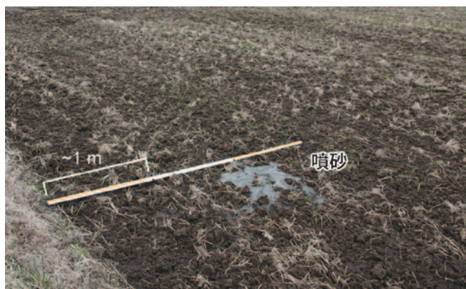
図3 東北地方太平洋沖地震直後における調査地の状況。左：水田のあちこちで見られた噴砂（2011年3月14日撮影）。右：河川沿いに見られた津波堆積物。写真は2011年4月7日に撮影されたものだが、地震後1ヶ月近くたっても津波堆積物は堆積構造などを保持していた。
