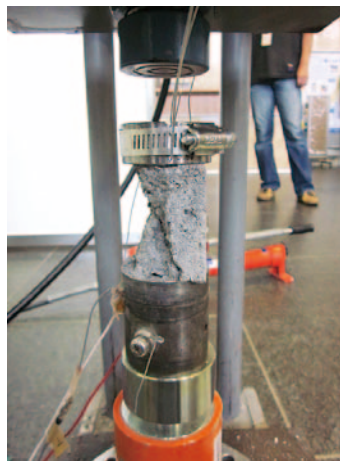
写真7 典型的な破壊後の試料。封圧がかかっていないので、側面にあったコンクリートは破壊の衝撃で飛ばされている。
