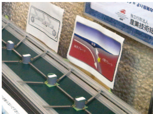
写真2 実際の沈み込み帯の断面と、実験装置でそれを模擬した様子。
