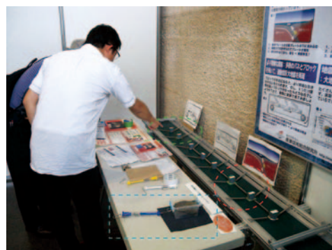
写真1 実験の様子と展示の全体像。ベルトコンベヤーの上にバネで繋いだブロックを配置。ブロックごとに摩擦力を変えたり（赤丸）、互いにバネで結ばない孤立したブロック（緑丸）も設定した。見学者に摩擦力の違いを体験してもらう（青四角）。
