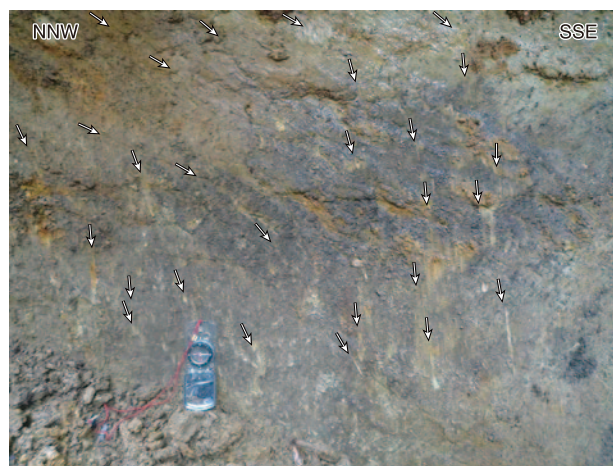
第8図 斉道地区の地震断層面にみられた湾曲した条線。矢印は断層下盤側（写真奥側）に対する断層上盤側（手前側）の移動方向を示す。2011年4月13日撮影。
