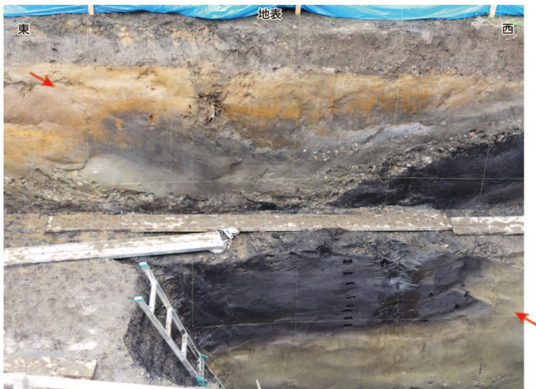
写真2 法林寺地区で実施したトレンチ壁面に出現した法林寺断層．赤矢印：断層，水系の間隔：1 m.
