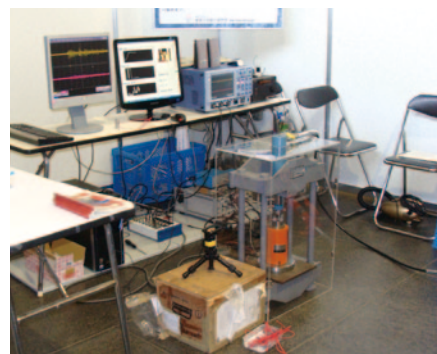
写真1 破壊実験の構成: 中央に載荷枠, 机の上にモニター, 机の下に計器類を配置。岩石の破片が飛び散っても見学者に当たらないよう載荷枠の周囲をアクリルの箱で覆っています。
