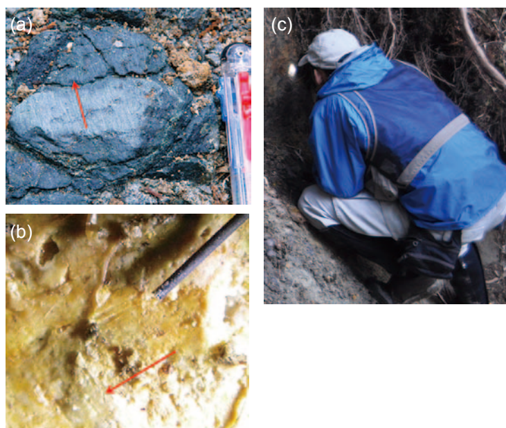
図1 断層面上の条線と断層面の観察風景。(a)と(b)の矢印は、条線の構造から判断された、写真とは反対側の岩盤の移動方向を表す。(a)破断ステップ非対称構造。(b)コメットマーク非対称構造。右上の黒い棒は0.5mmシャープペンシルの芯。条線左にある0.5mmほどの砂粒から右上に彗星の尾っぽのように条線が延びている。(c)露頭での断層面の観察風景。条線に陰影をつけて観察しやすくするため、断層面を高輝度LED電灯で照らしている。
