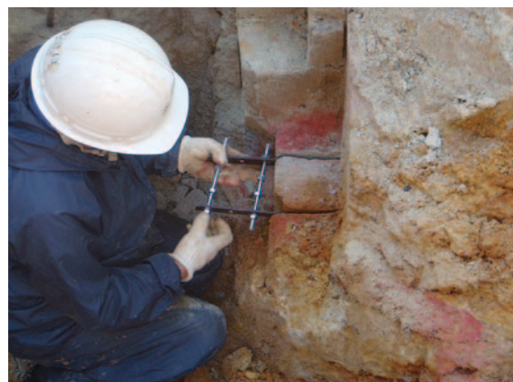
写真1 断層を含む岩盤ブロックの切り出し風景。
