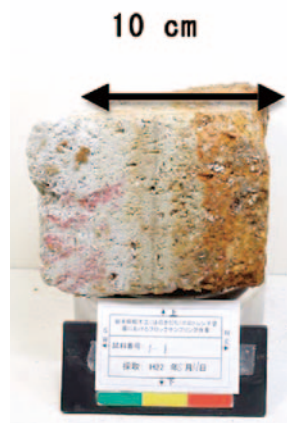
写真2 切り出した岩盤ブロック。茶色に見える方が断層の下盤にあたる。
