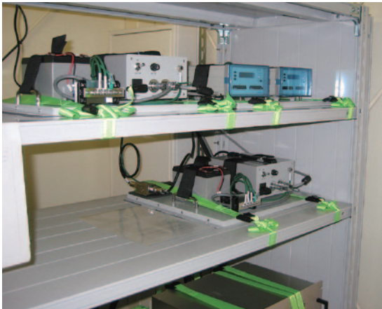
写真 2 孔底地震観測装置用のデータ収録装置 (株式会社計測技研製)。観測小屋内のアングル棚にしっかりと固定します。
