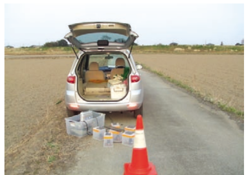
写真 2 半径 30 cm の微動アレイ。微動計に風避けとなるプラスチックケースを被せ、車の後ろ側に設置した状態を示す。
