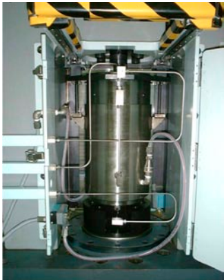
ガス圧式高温高压変形実験装置。
