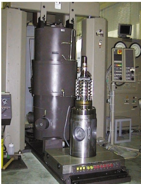
大型岩石試料用高温高压岩石試験装置。
