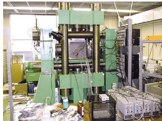
大型二軸断層運動実験装置。
