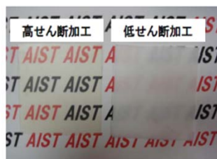
試料の比較写真 (試料はPC/PMMA=80/20ブレンド、 試料サイズ:100×100×0.5mm) 左:透明な高せん断加工試料 右:白濁した低せん断加工試料
