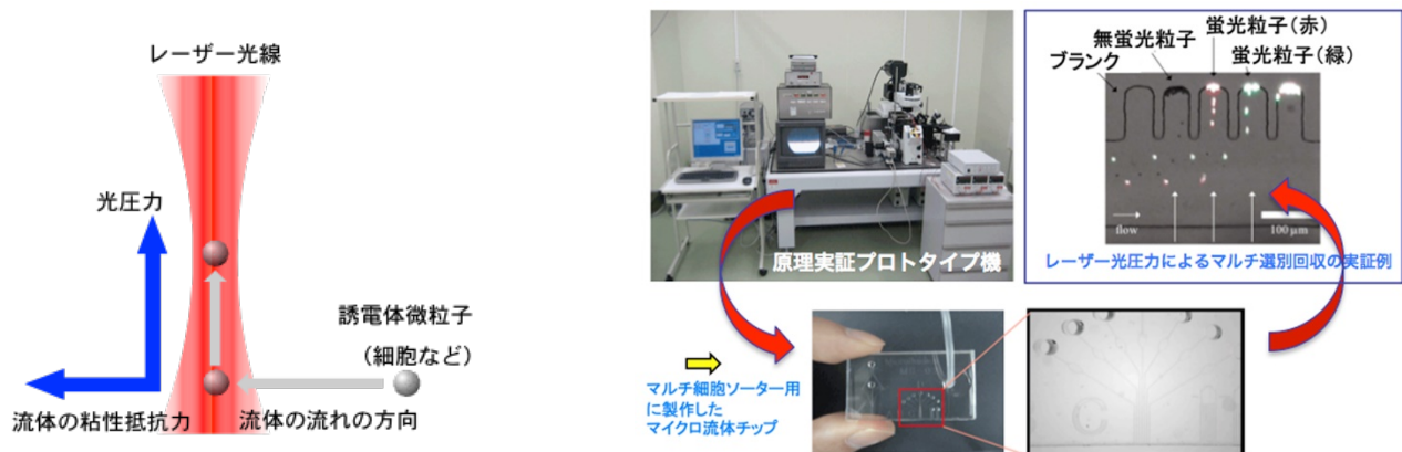
レーザー光圧とマイクロ流体チップによるマルチソーティングの原理（左図）と実証図（右図）
