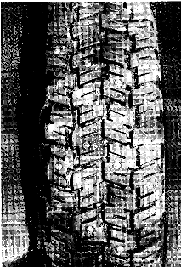
写真IV-4 1万 km 走行後の A 社スパイクタイヤ
