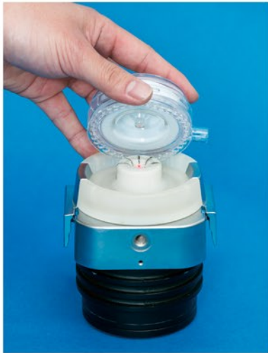
開発した可視・近赤外光血栓センサ
