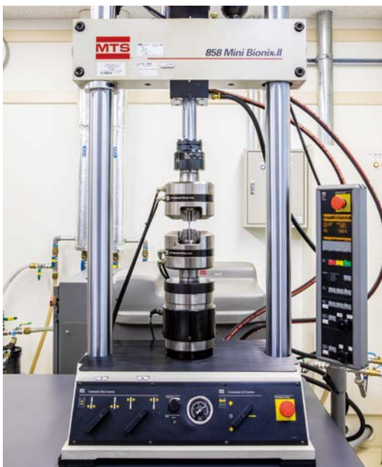
インプラントの耐久性を評価するための装置。 1,000万回以上の負荷をかけることができる。
