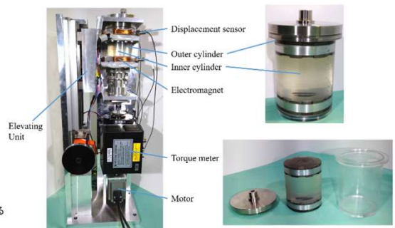
図2 血流を模擬したせん断負荷装置 (東京科学大学との共同研究)
