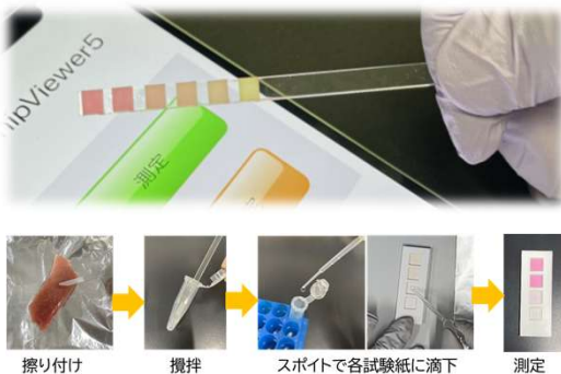
図1 スマホと試験紙の鮮度測定キット
