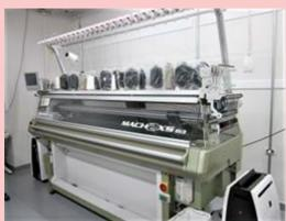
Fig.1 センサウェアの作製に使用した無縫製横編機 (MACH2-XS 153, 島精機)
