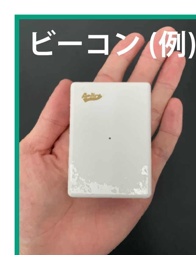
測位したい範囲へ BLE ビーコンを設置
