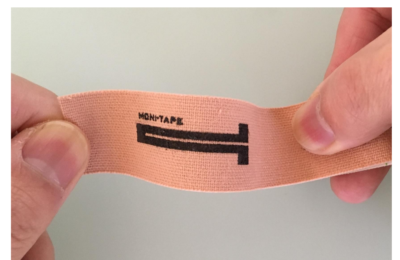
作製したテープ状センサーの外観 市販の医療用テープを基材として 利用したひずみセンサーを作製 伸縮性があり、使用感が良好
