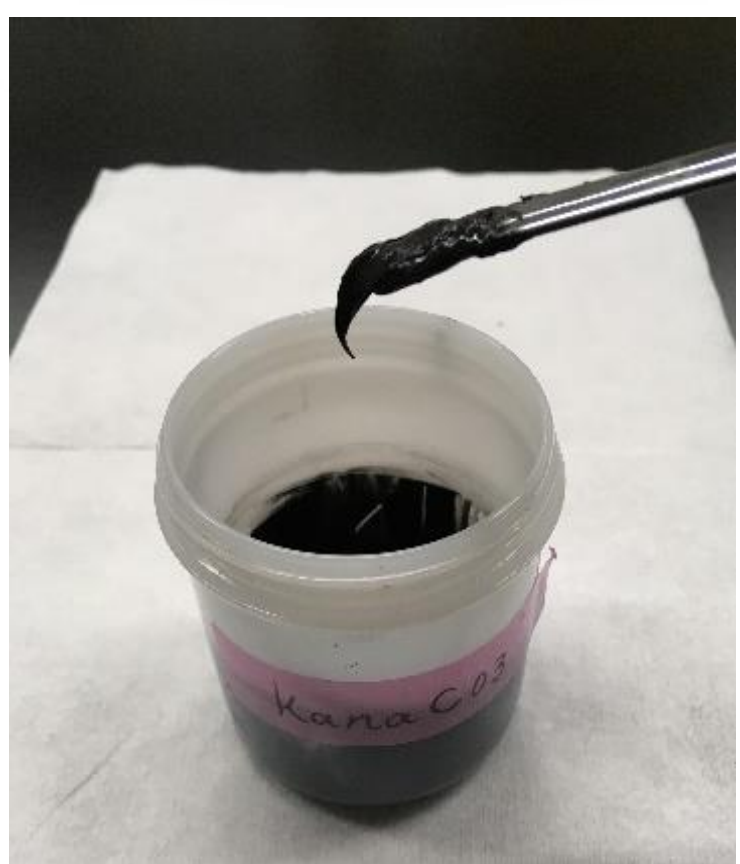
ひずみ検出用導電インク 導電粒子、樹脂、分散剤、溶媒を混合
