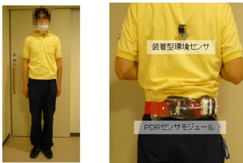
図 2. 3. 4-1 PDR センサモジュール装着位置（左：全身、右：拡大）
