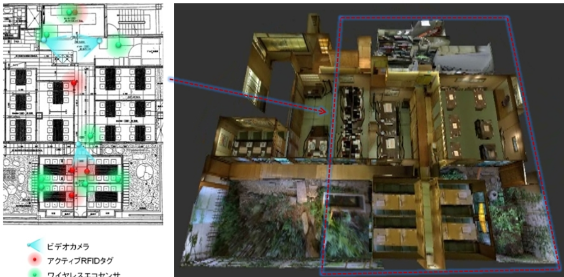
図 2.2.2-12 設置型センサの配置 (左) と仮想化された実店舗モデル (右)
