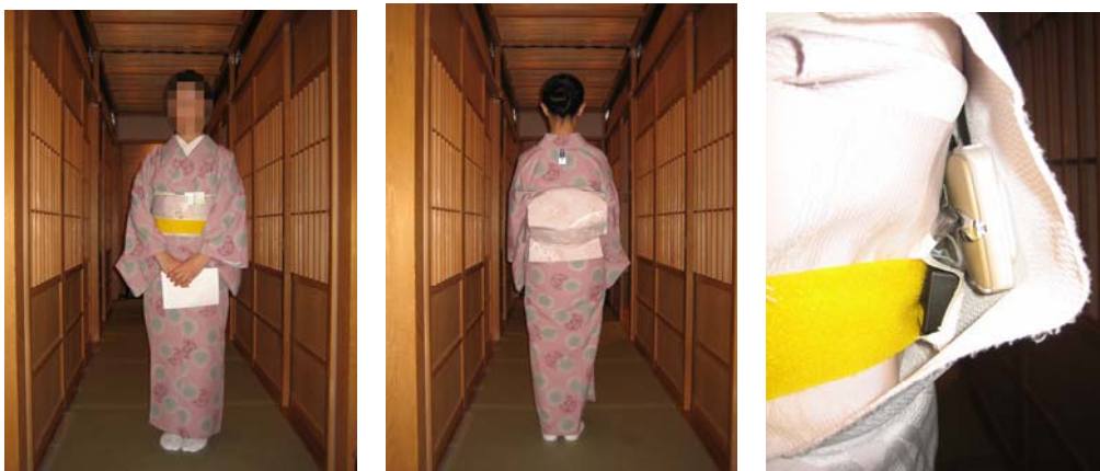
図 2.2.2-11 PDR センサモジュール装着位置 (左：正面，中央：背面，右：お太鼓内)
