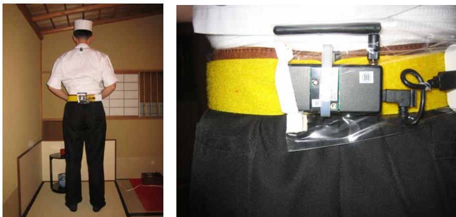
図 2.2.2-10 PDR センサモジュール装着位置 (左：全身，右：拡大)
