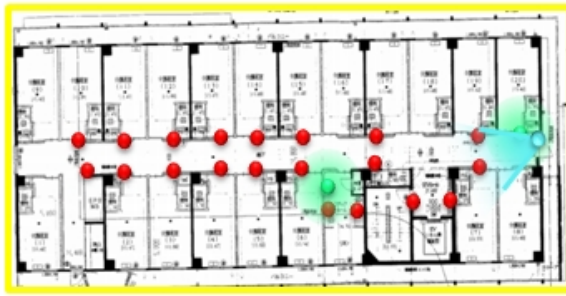
2階のセンサ配置 (実験後の検証用に多めに配置)
